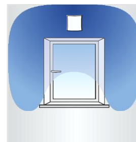
Õhuvoolu jaotumine regulaatori erinevate asendite korral
